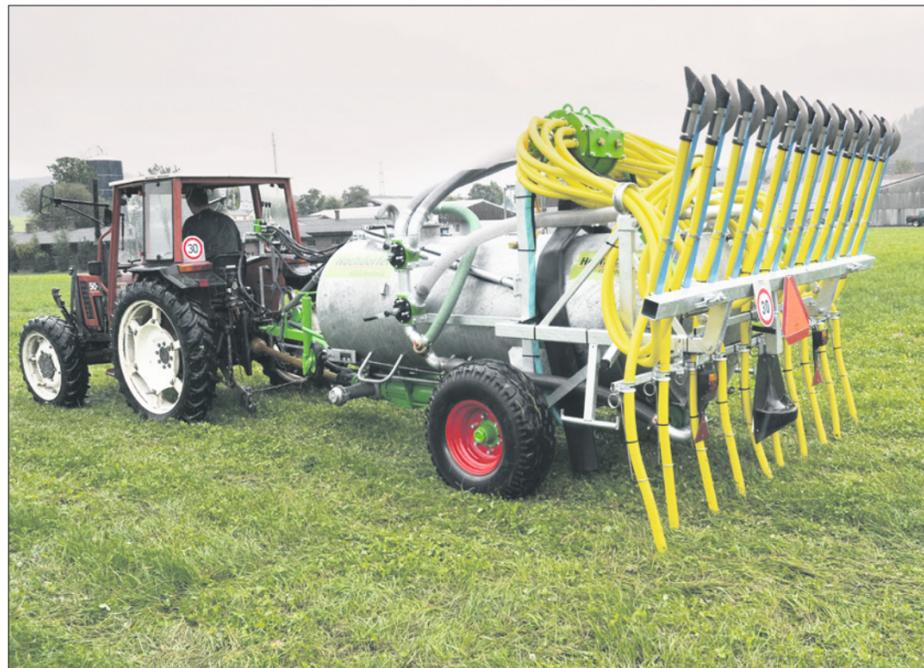
Mit dem extra für die Versuchspartellen konstruierten Güllefass wurden im Thurgauer Gülleapplikationsprojekt die verschiedenen Gülleausbringungsmethoden verglichen.
